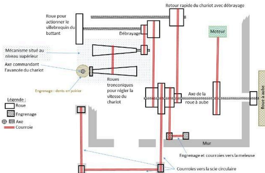
Dessin schématique du mécanisme situé au sous-sol.
