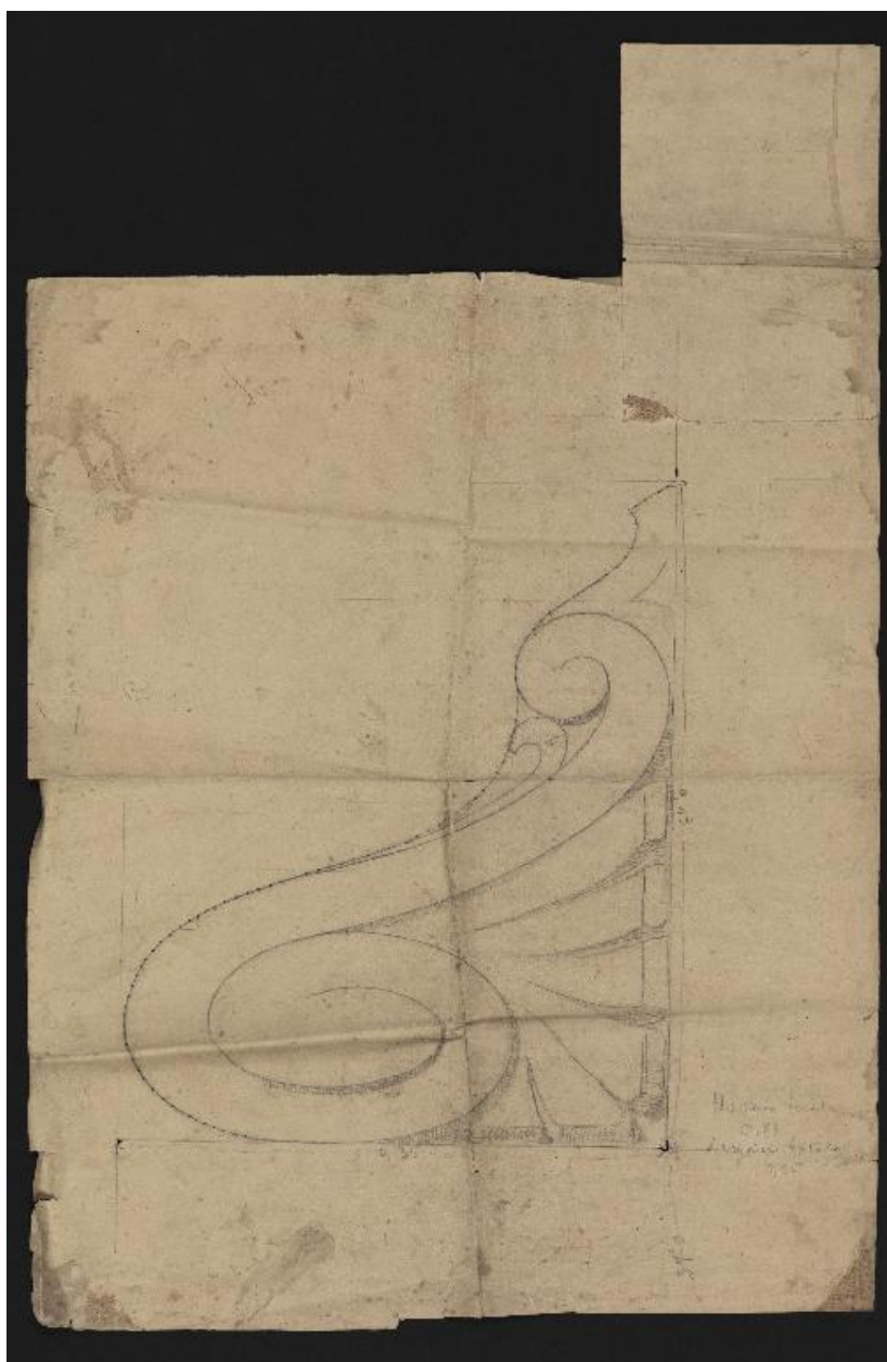
Plan d'exécution, verso : poncif de l'aileron à volutes grandeur nature
