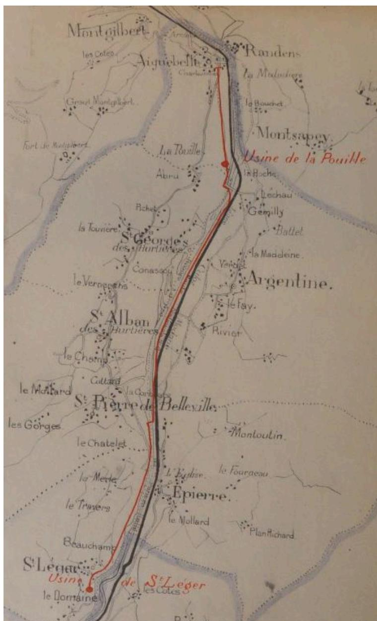
Plan de la ligne HT entre l'usine de la Pouille et la centrale hydroélectrique de Saint-Léger, 1927 (FR.AD073, S579).
