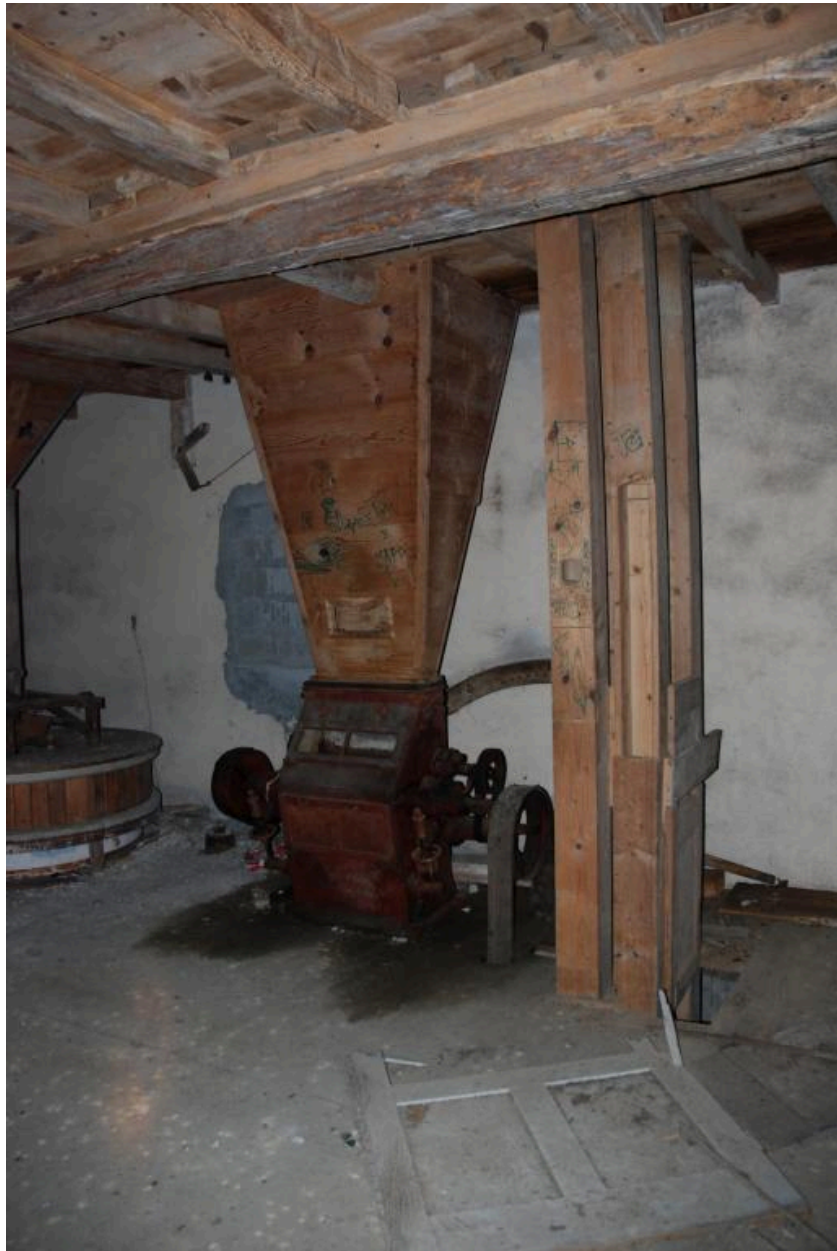
Vue intérieure du rez-de-chaussée, partie nord : machine à cylindre, trémie à godets.
