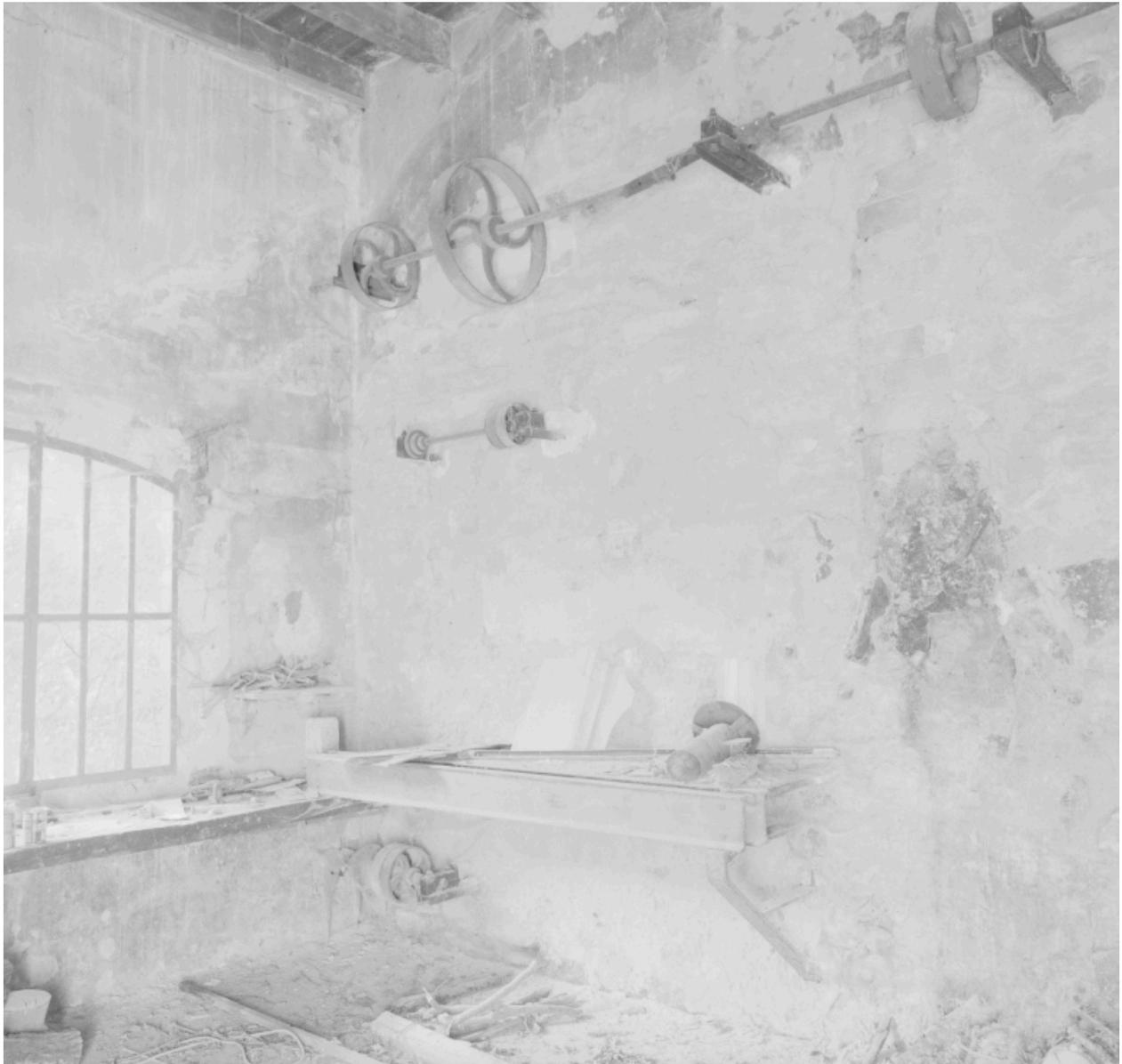
Moulin, essieu d'entraînement des courroies.
