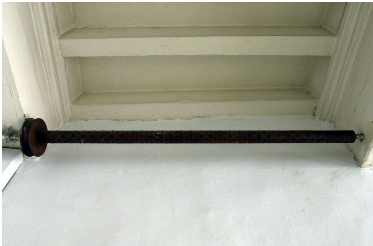
Bâtiment 3, 3e étage, pièce ouvrant sur la cour I et aménagée en atelier, mécanisme de transmission des anciennes machines, détail
