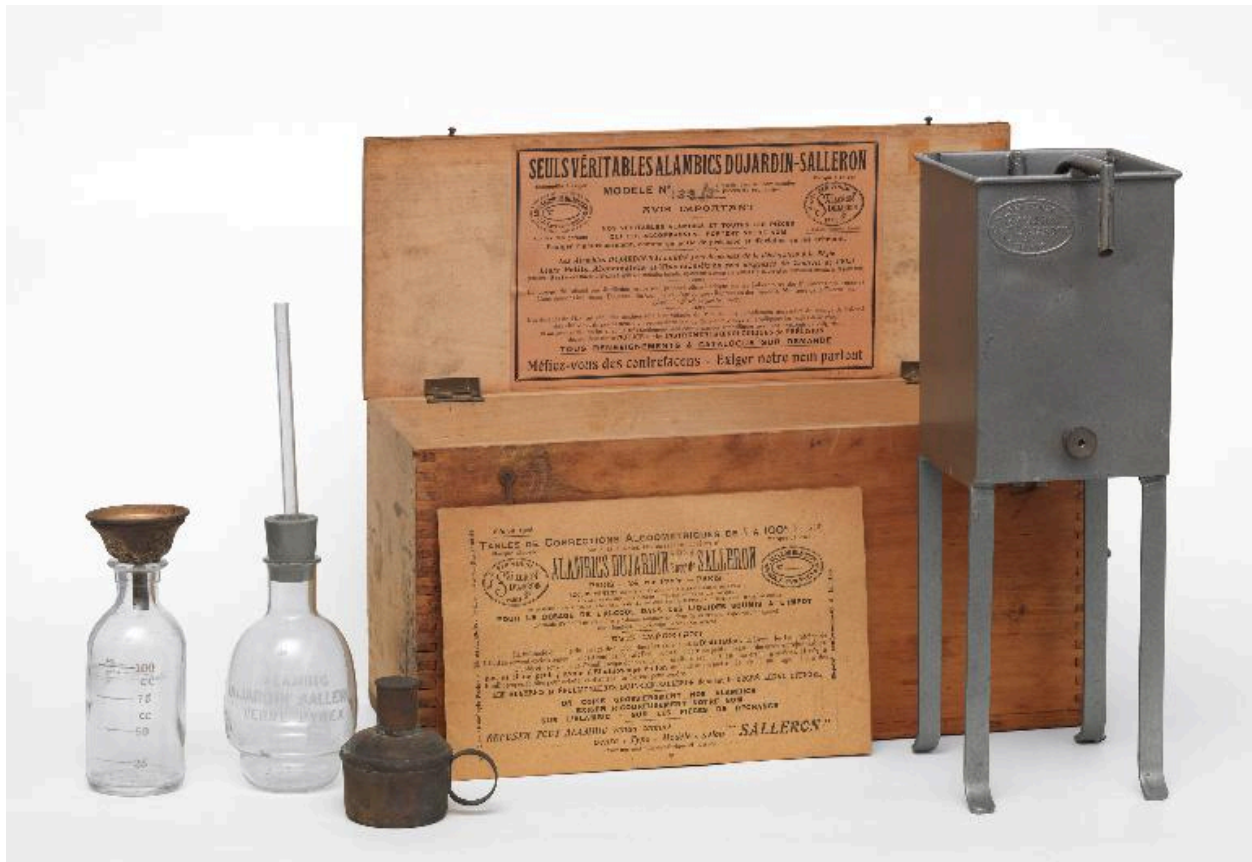
Vue d'ensemble : boîte de rangement, alambic, flacons doseurs, entonnoir, réchaud
