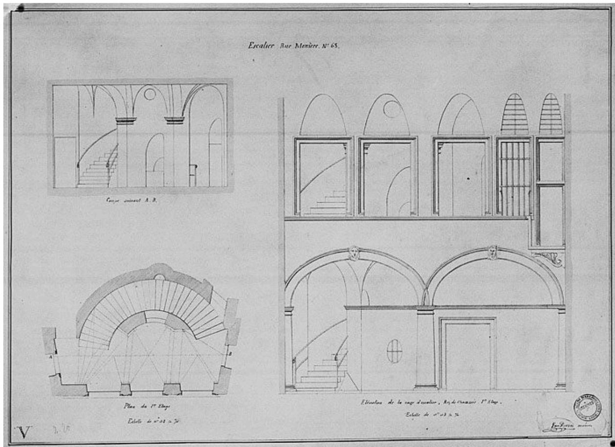
Relevés d'architecture par Marius van Doren. Plan de l'escalier, élévations de la cage sur un et deux niveaux
