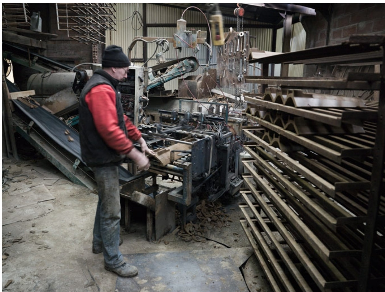
Sortie des tuiles avant cuisson, mouleuse
