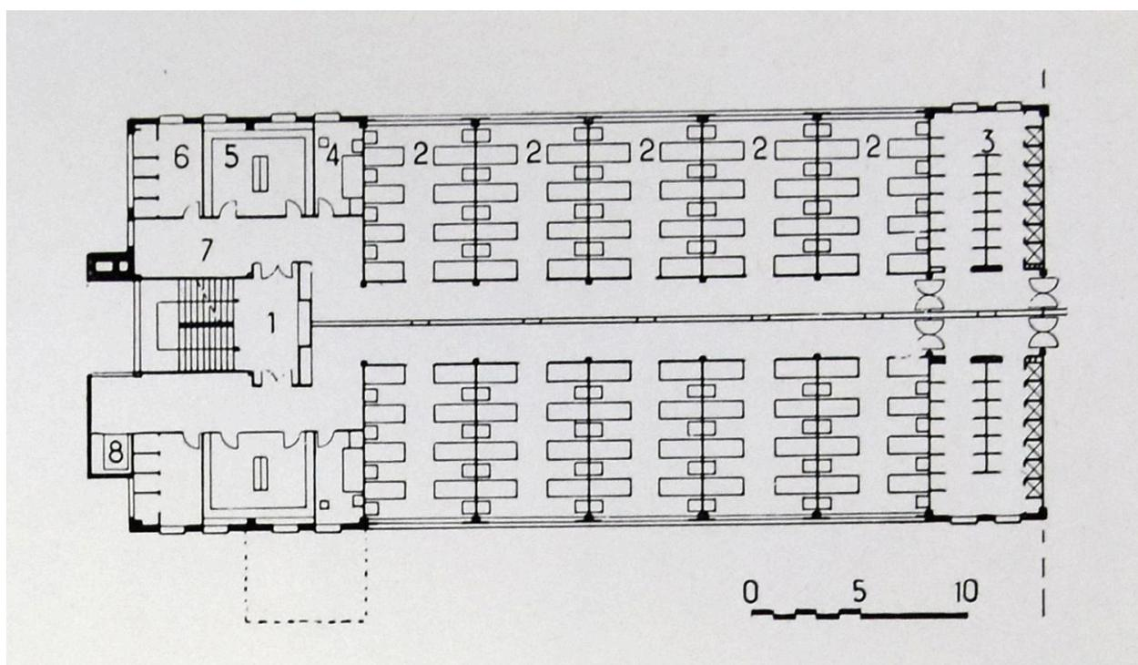
Demi plan d'étage courant : 1 palier, 2 Chambre à 8 lits, 3 Lavabos et douches, 4 Surveillant, 5 Cordonnerie, 6 Sanitaires, 7 Porte-manteaux, 8 Monte-charge, v. 1961 (Phot. Littoz-Baritel In Noviant, Internat du lycée de garçons, 1963)
