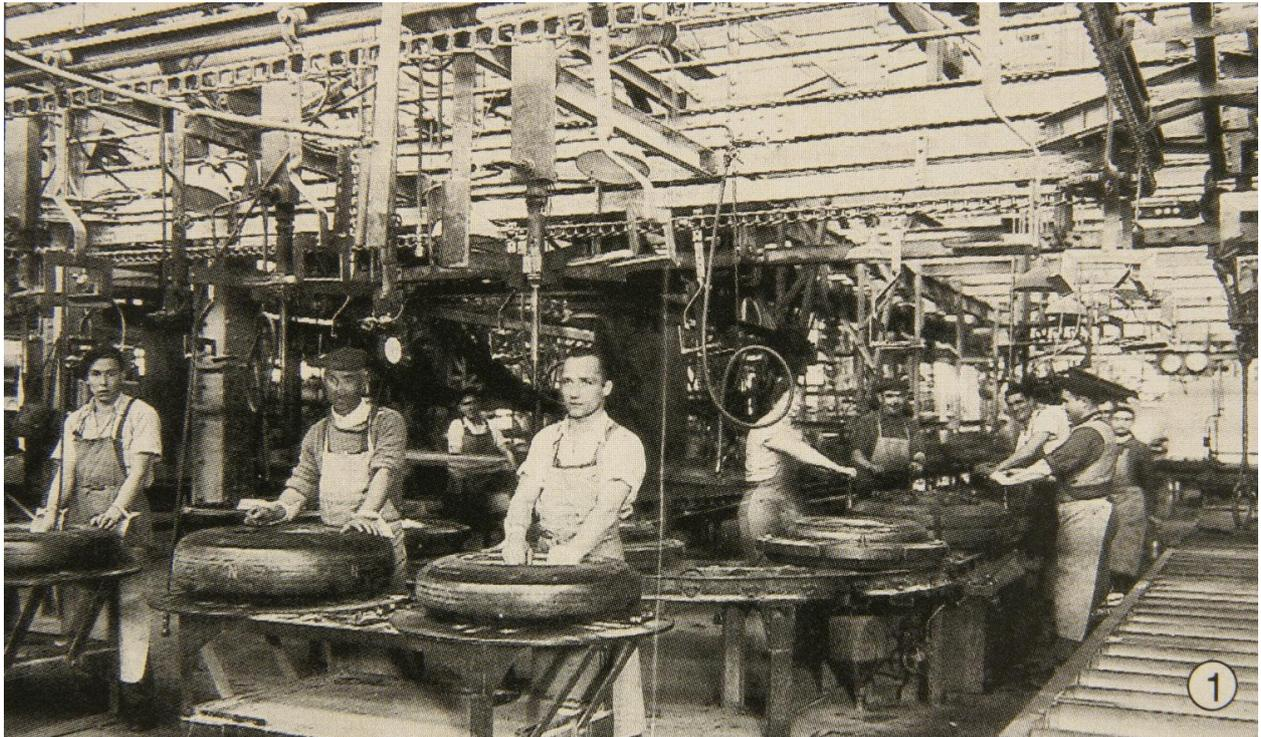
Intérieur d'un atelier des usines Michelin : la cuisson des pneumatiques en autoclave.
