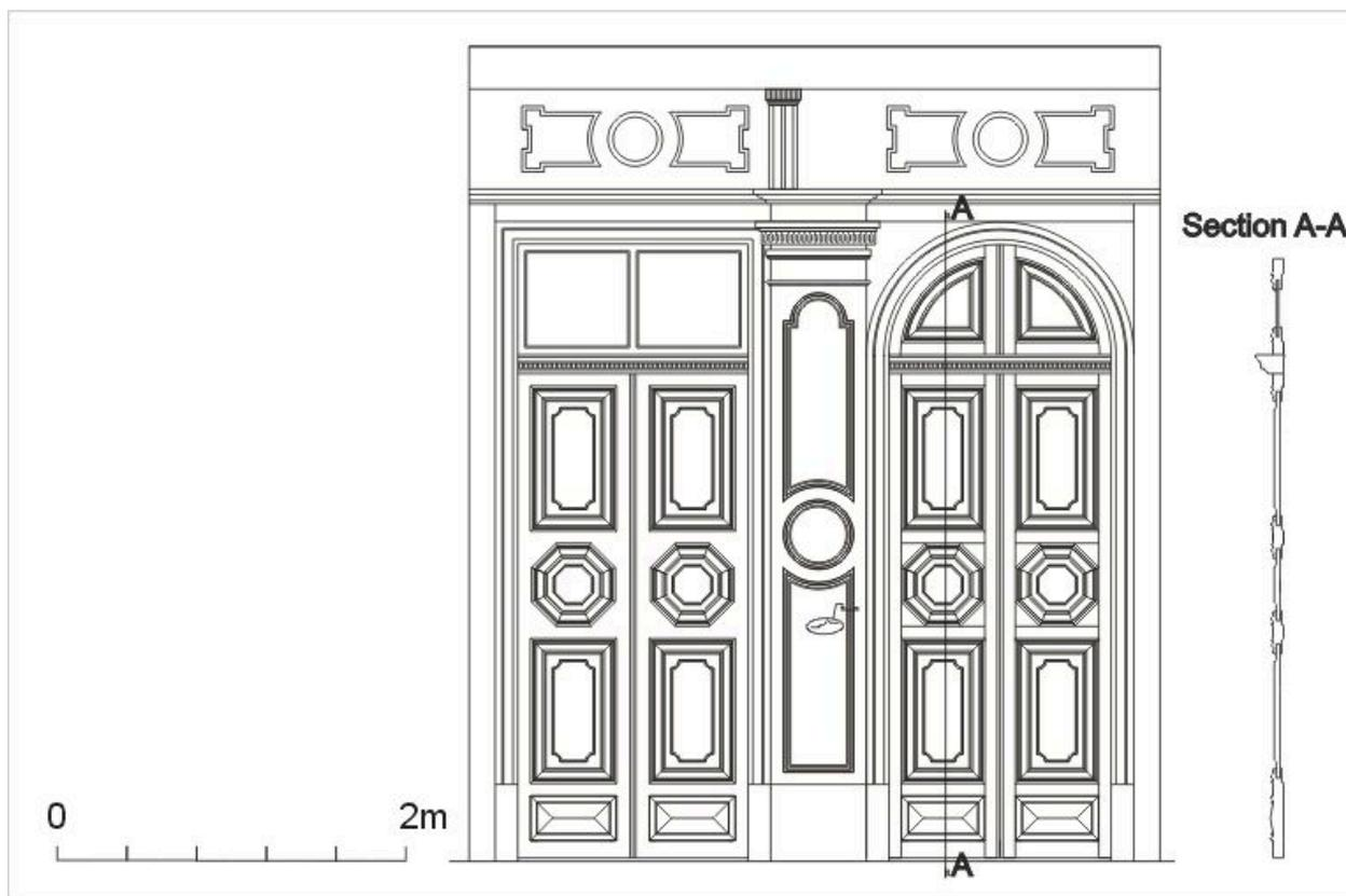
Élévation de la façade principale, détail de la porte (à gauche), d'après un relevé photogrammétrique par A. Bensaci, 2002
