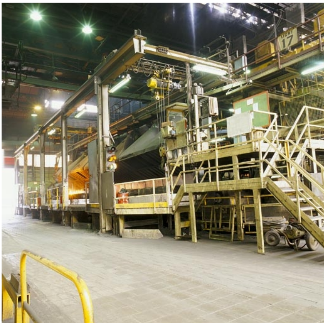
Fonderie : ligne 17, ligne de moulage par impact, remplissage des moules de fonte liquide.
