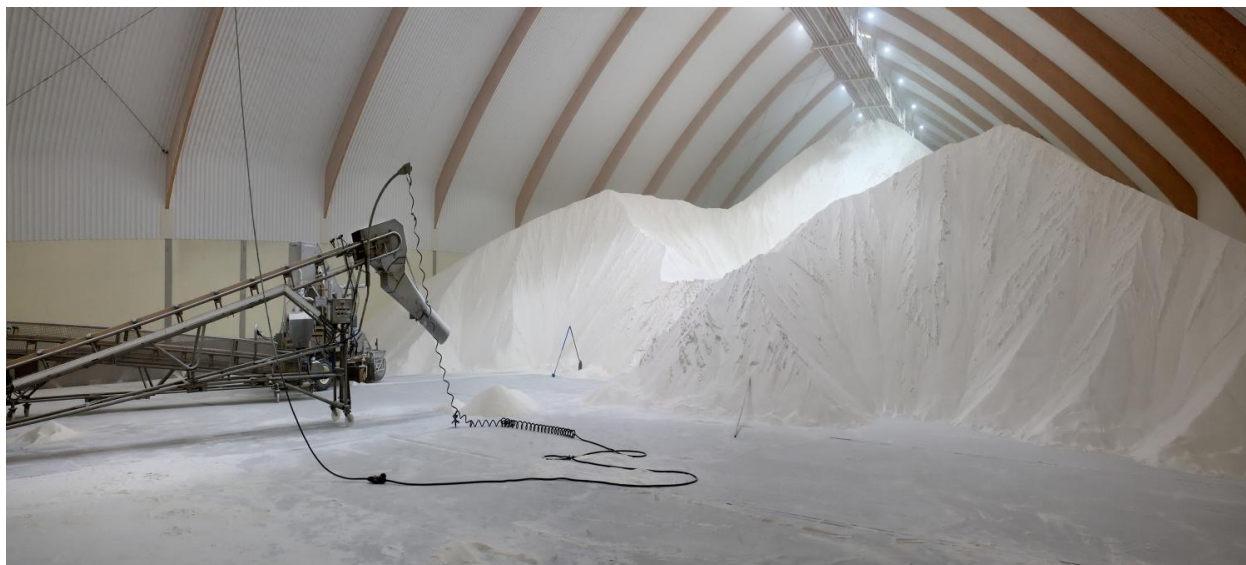
Collecteur-transporteur du sucre du silo (pour vider le silo)
