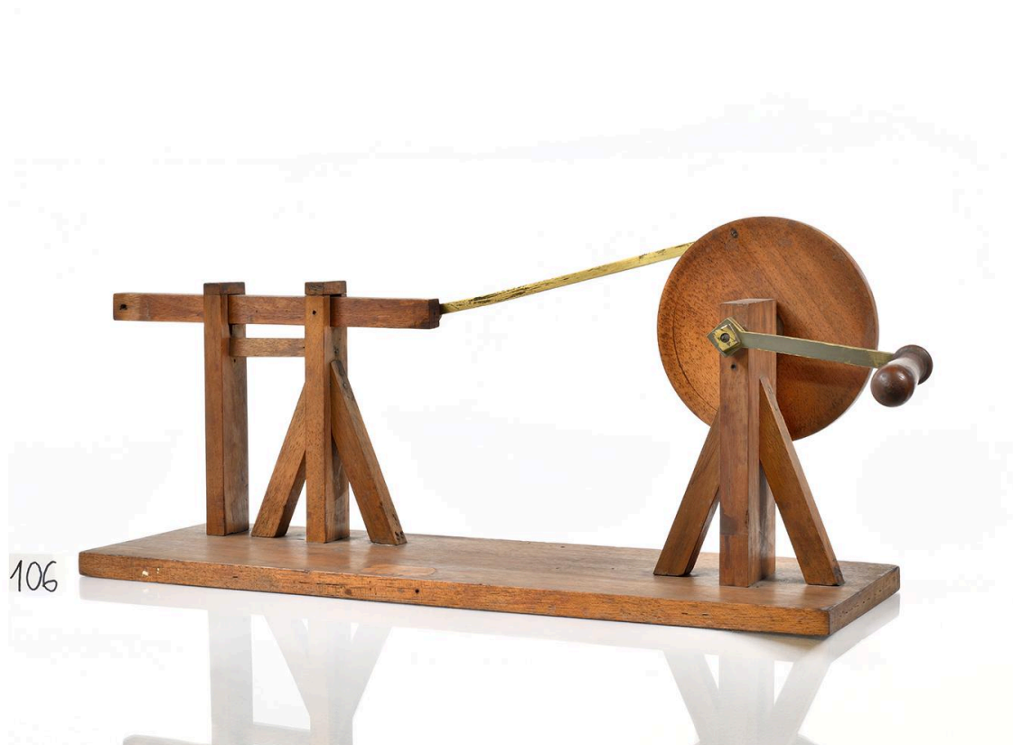
Mouvement circulaire continu changé en rectiligne alternatif, exemplaire 1, vue 3
