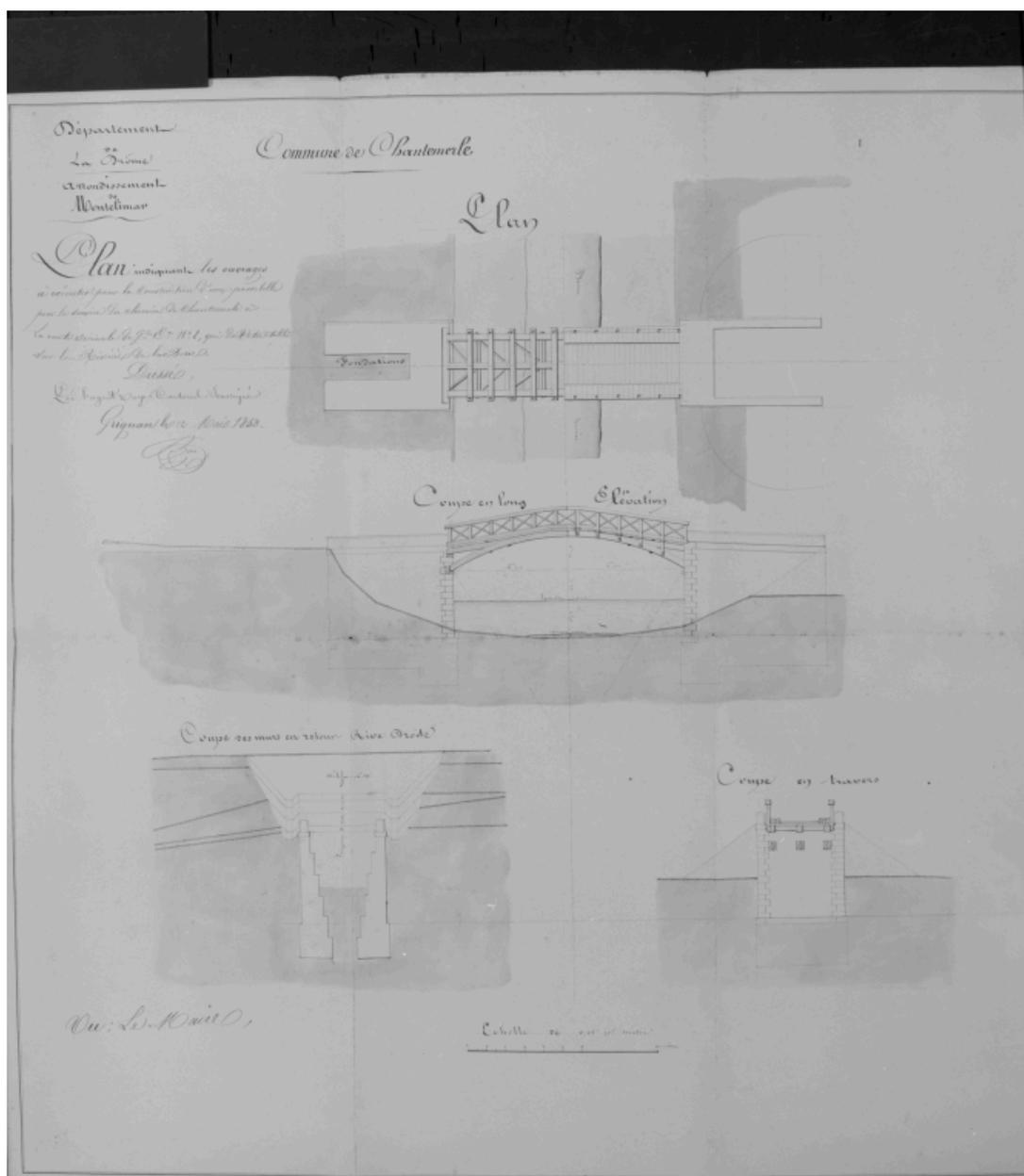
Commune de Chantemerle. Plan indiquant les ouvrages à exécuter pour la construction d'une passerelle pour le service du chemin de Chantemerle à la route vicinale de grande communication n° 8 qui doit être établie sur la rivière de la Berre. Plan, coupes et élévation. Dressé par l'agent voyer cantonal Chaix. Grignan, le 12 mai 1853.
