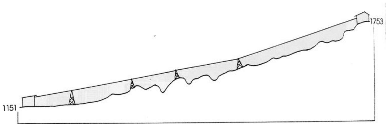
Coupe de principes montrant le dénivelé du téléphérique de Rochebrune (602 m et 1 945 m de câble portés par 4 pylônes).
