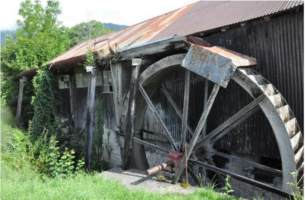
Détail de la roue hydraulique de la scierie.
