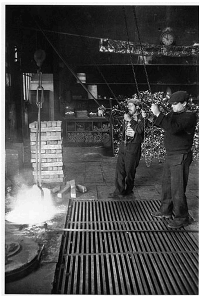
Sortir du creuset en fusion (phase 2)
