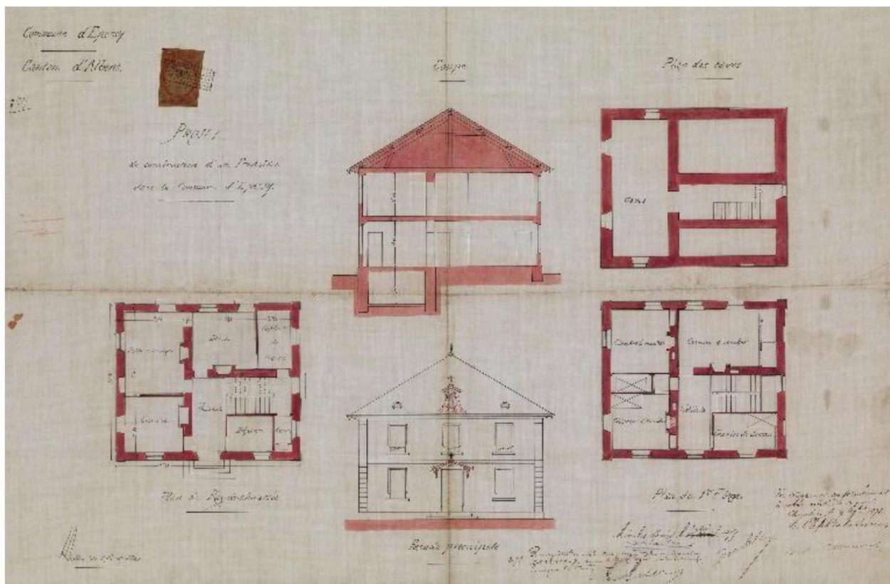
Projet de construction d'un Presbytère dans la commune d'Epersy. Plan des caves. Plan du Rez-de-chaussée. Plan du 1er étage. Façade principale. Coupe. Grisard, 1875 (AD Savoie, 2O : 1332).
