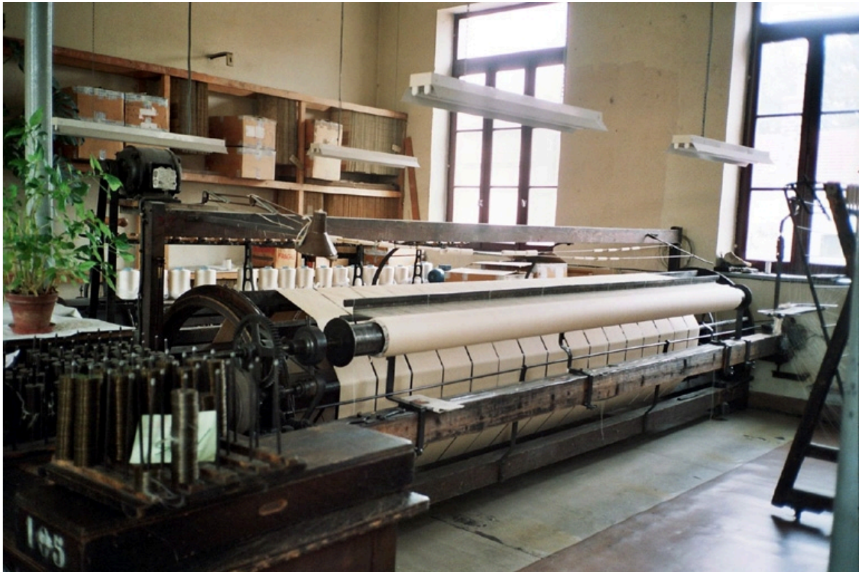
Ourdissoir horizontal, atelier de préparation des fils au premier étage
