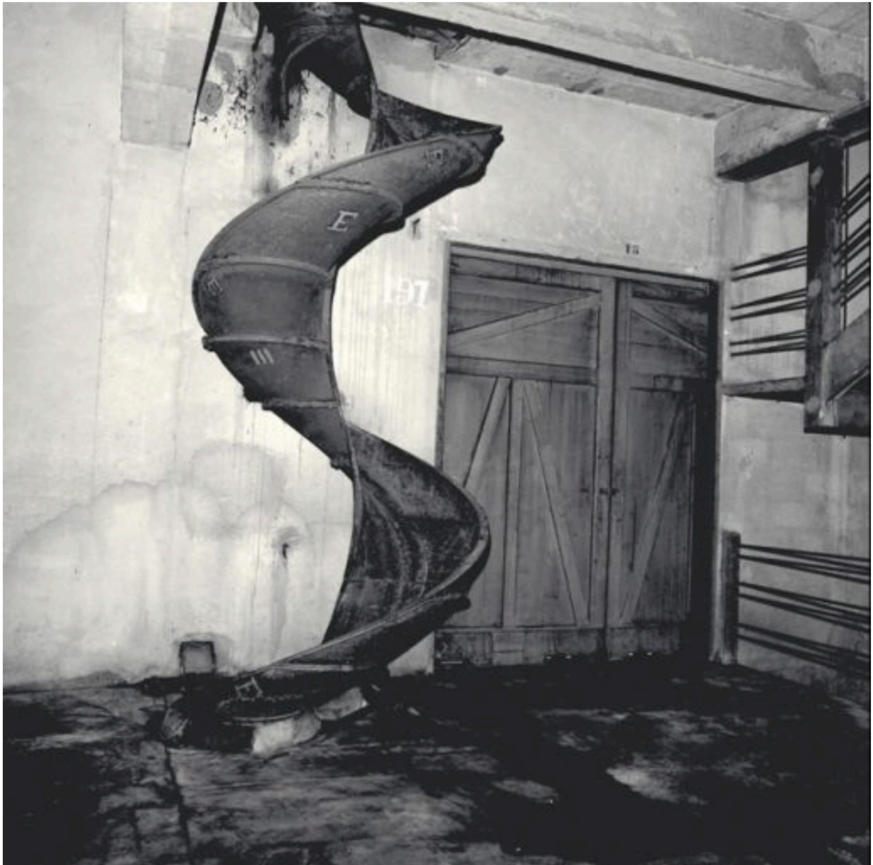
Intérieur du bâtiment de 1927 (bâtiment sud) : manutention du sucre en sac, à l'étage, le tourniquet de l'angle sud-est et la porte de déchargement
