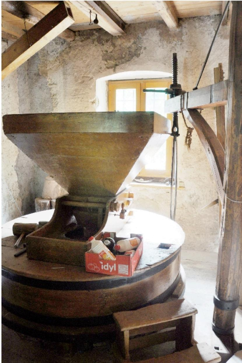
Rez-de-chaussée surélevé : vue de la meule avec la trémie et de l'outillage pour le repiquage de la meule.
