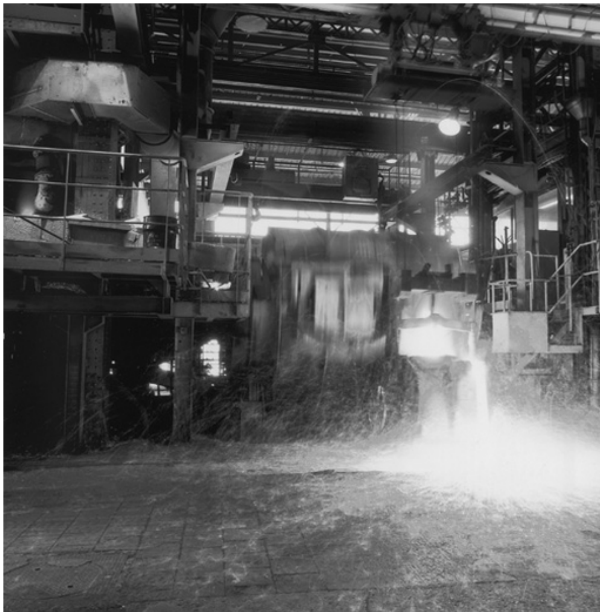
Cubilot : coulée en fusion (débordement).
