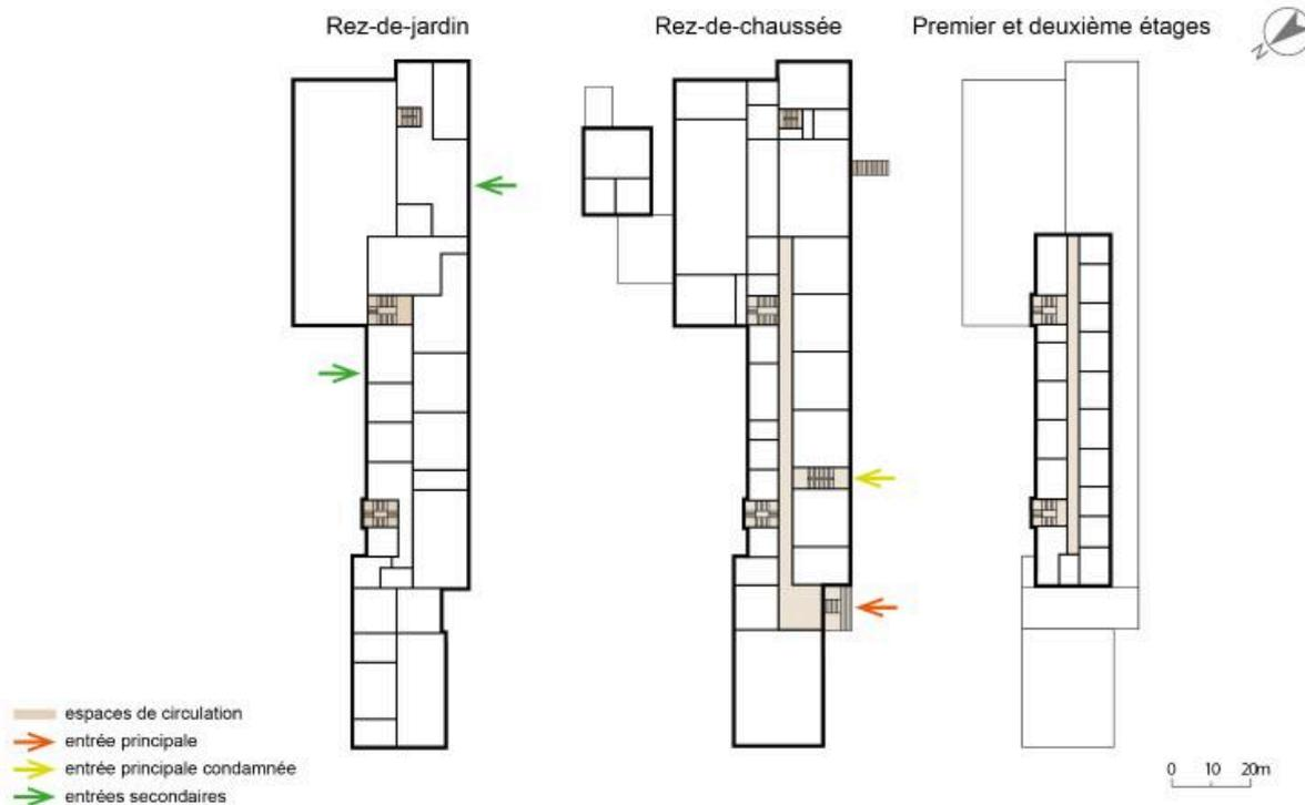
Plan schématique des trois niveaux, état 2019 : une des deux entrées principales d'origine a été condamnée pour recevoir l'infirmerie.
