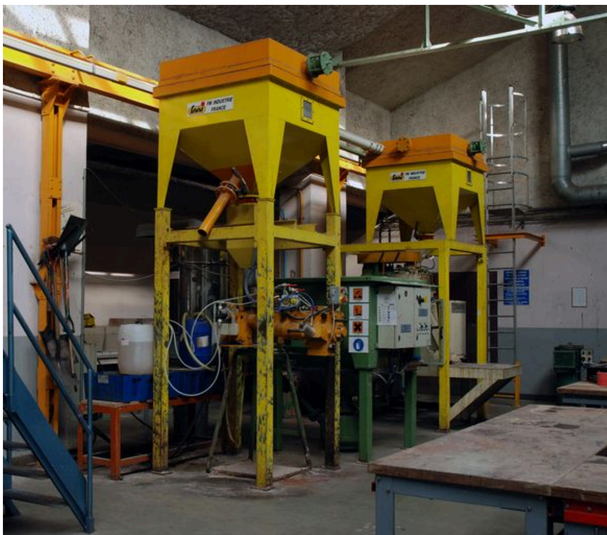
Préparateur et malaxeur de sable chimique FM INDUSTRIE et ARABAMENDI
