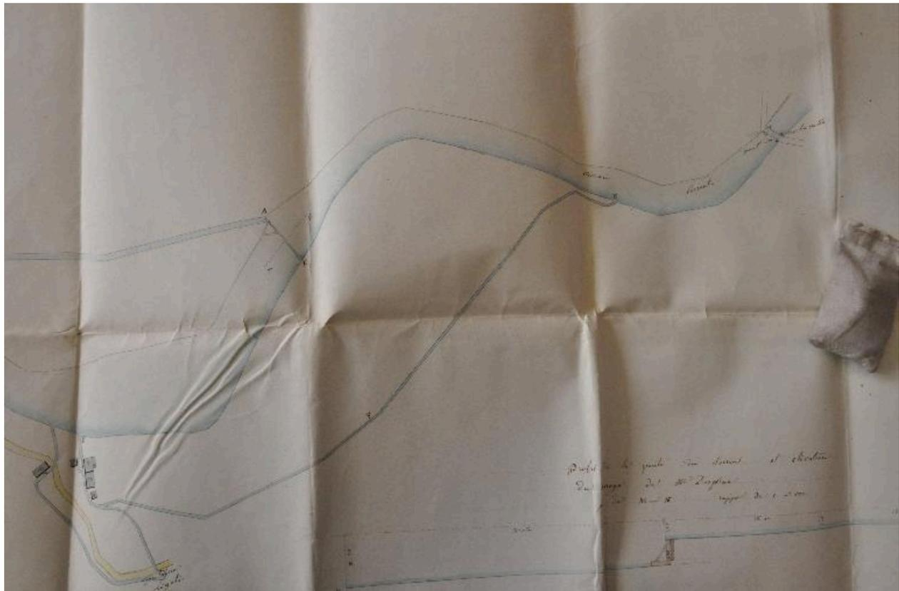
Plan de la prise d'eau des moulins Despine faisant apparaître les moulins de Leyat (FR.AD073, 1FS2445).
