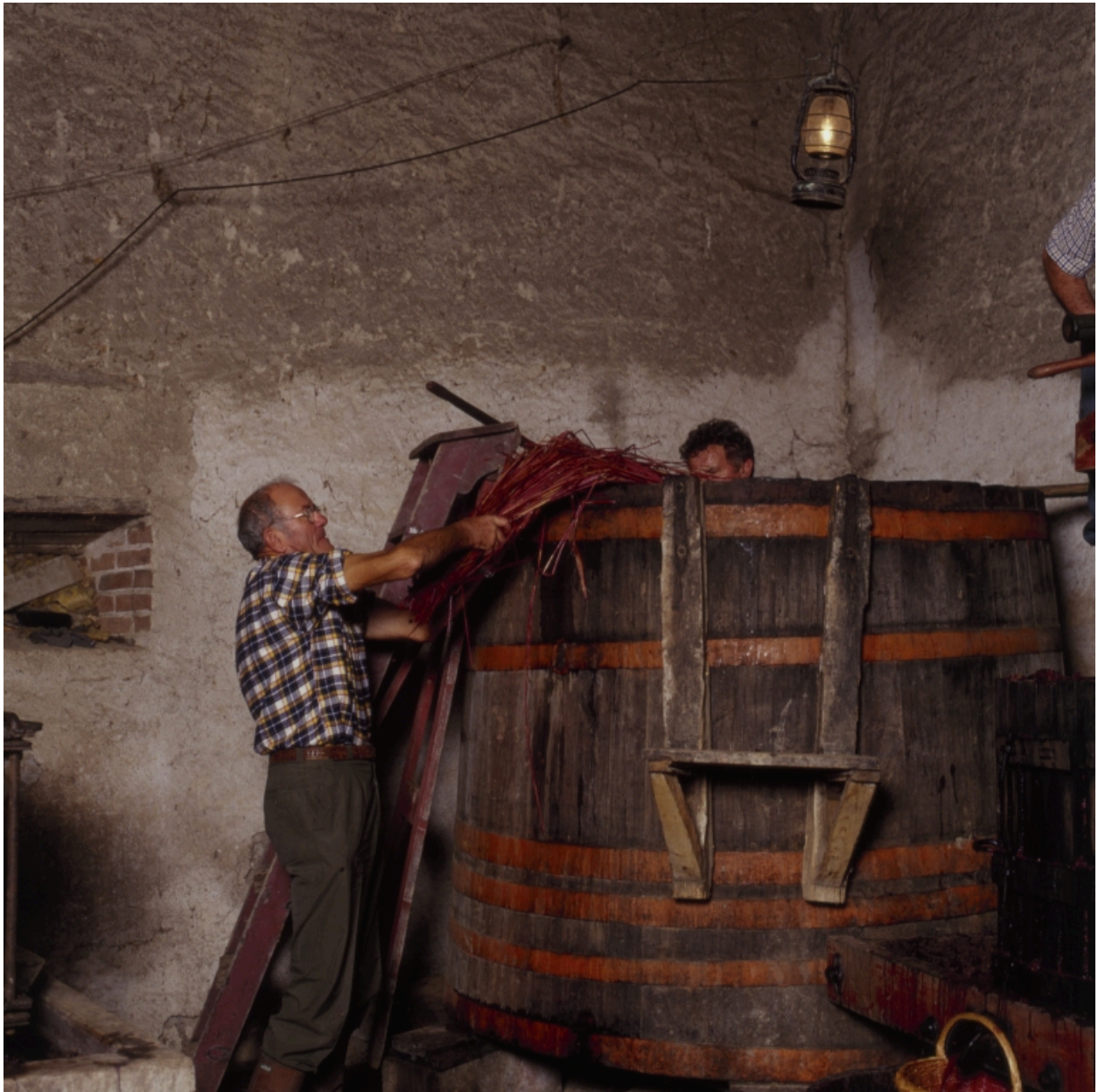
Cuvage à Champdieu (canton de Montbrison). Dans le fond de la cuve, un "paillon", filtre de paille de seigle, reçoit le raisin préalablement broyé.
