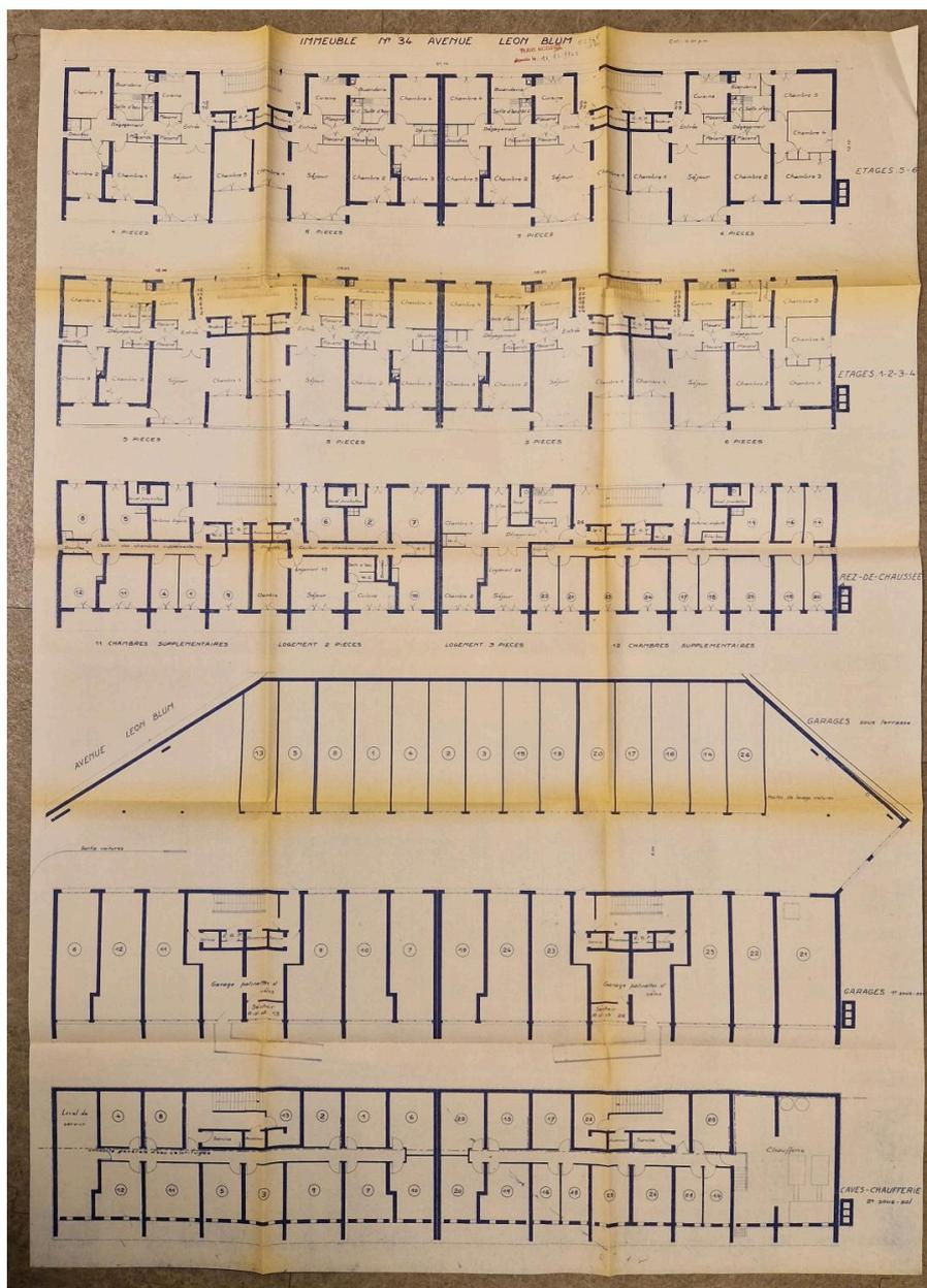
Plans modifiés des différents niveaux de l'immeuble : étage des caves et de la chaufferie, étage des garages au 1er sous-sol et sous la terrasse, rez-de-chaussée et étages 1 à 6.
