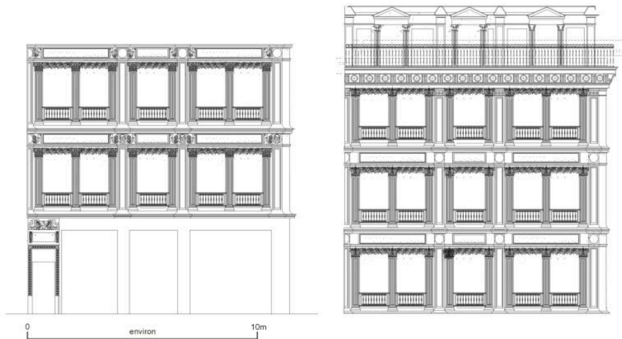
Élévation en deux parties sur la place d'Albon, d'après un relevé photogrammétrique par A. Bensaci, 2005
