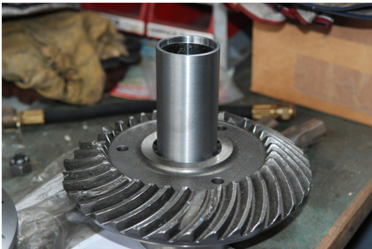
Engrenage avec dentelure spiro-conique
