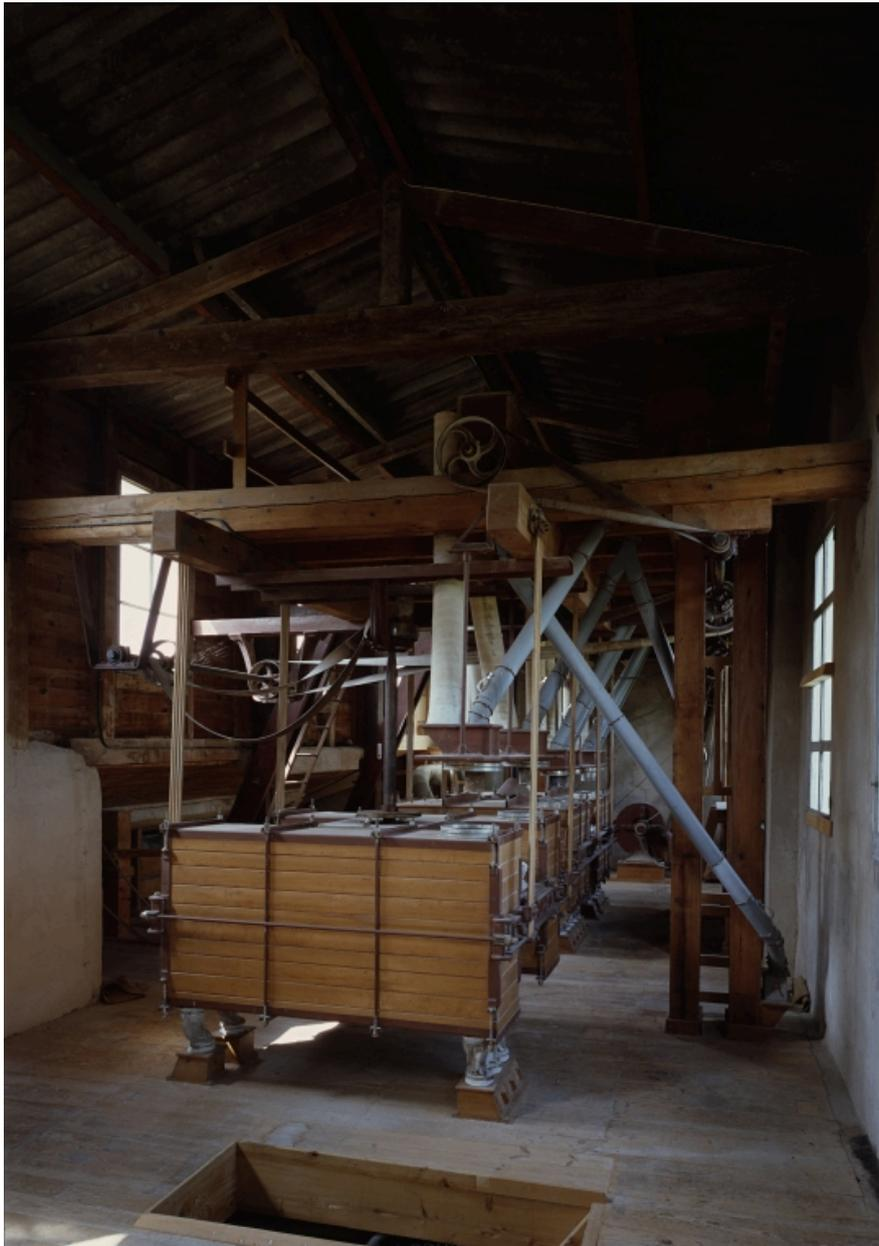
Etage en surcroît et comble : salle des plansichters (tamis de sûreté).
