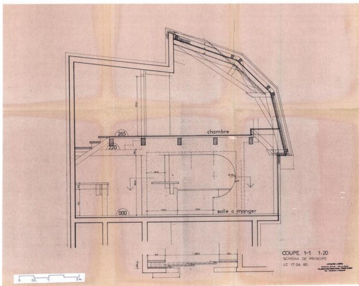
Détails d'exécution. Juin 1980. Coupe 1-1. Schéma de principe / J. Labro (A. privées J. Labro)
