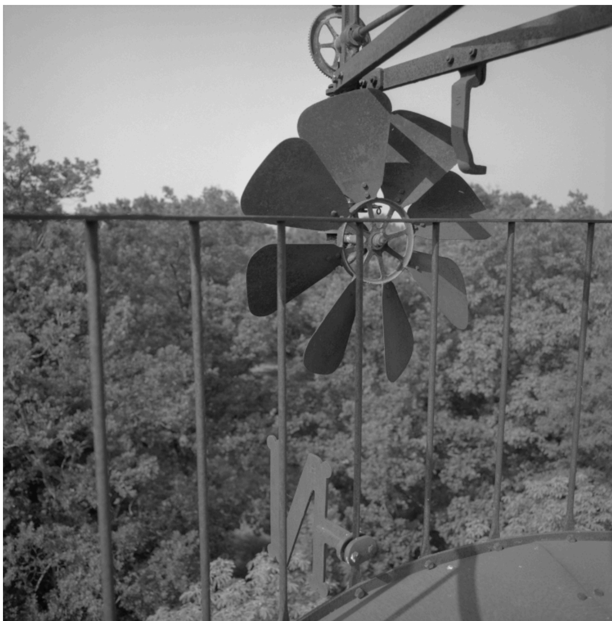
Détail du gouvernail de l'éolienne.
