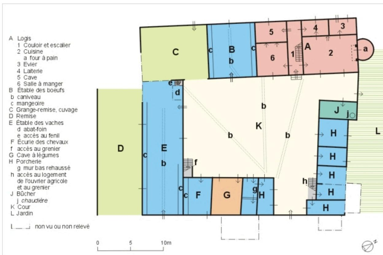
Plan du rez-de-chaussée. Schéma.
