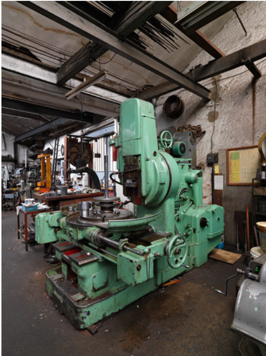
Machine MAAG : taillage par génération (1 cycle) pièce de 1 m de diamètre
