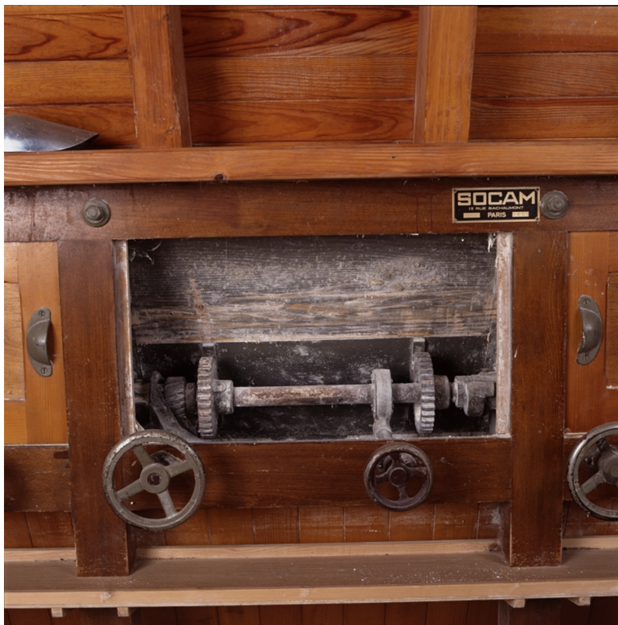
Détail de trémie, mélangeur (regard ouvert).
