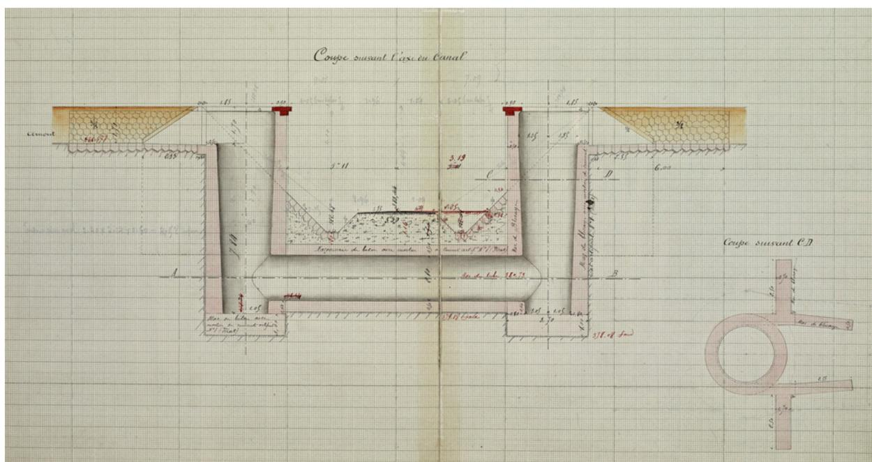
Canal du Forez. Branche principale. Achèvement. Projet d'exécution de la 5e partie dite de Montbrison. 2e lot d'adjudication (...) Type de siphon (...) sous deux chemins d'exploitation aux profils n°14-15, 19-20. 1886.
