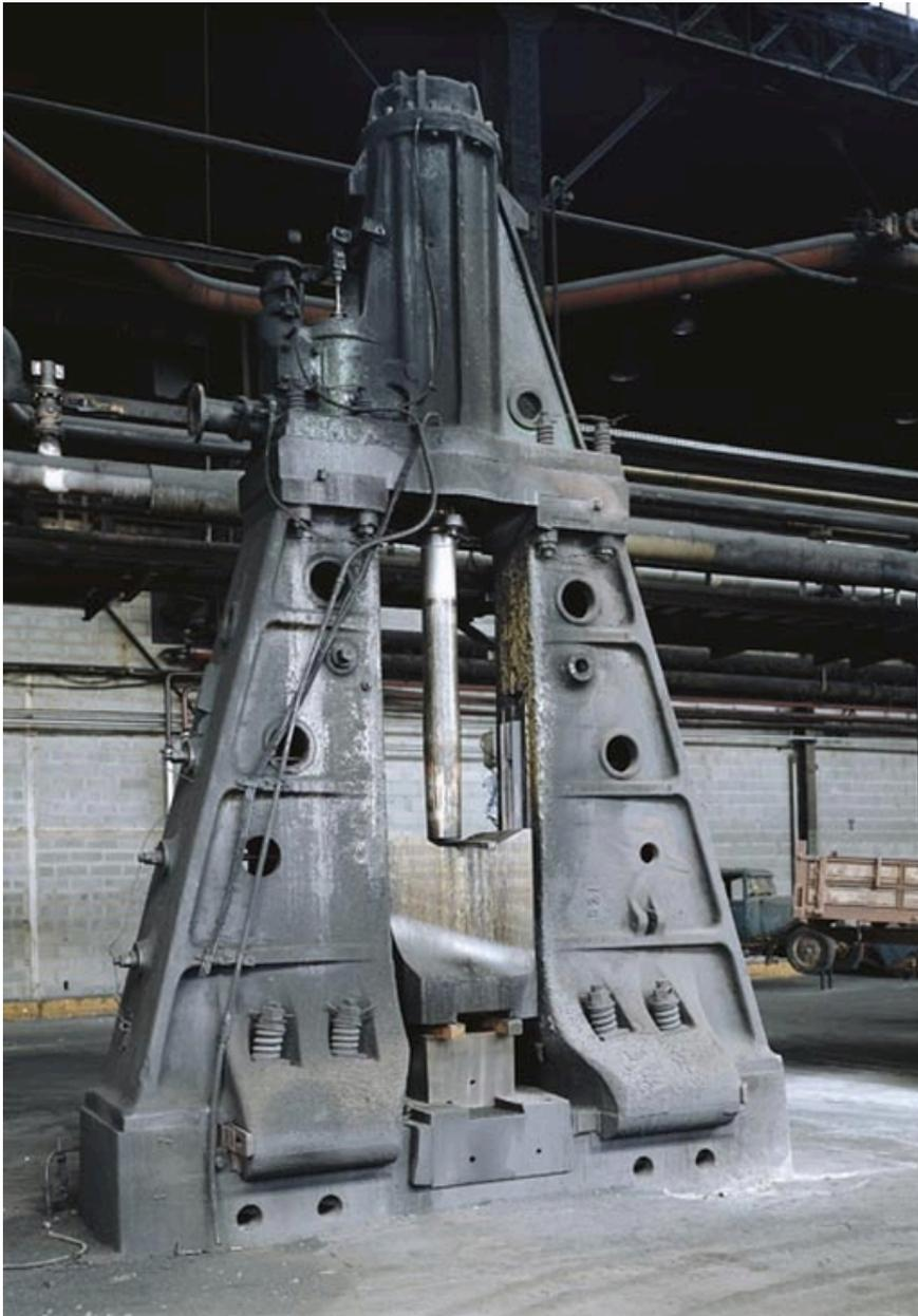
Marteau pilon (15 tonnes) qui a fonctionné à la vapeur (centrale vapeur) puis à l'air comprimé (forge).
