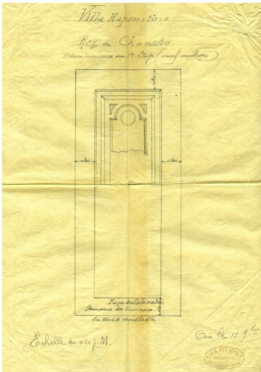
Dessin d'un trumeau d'une élévation latérale
