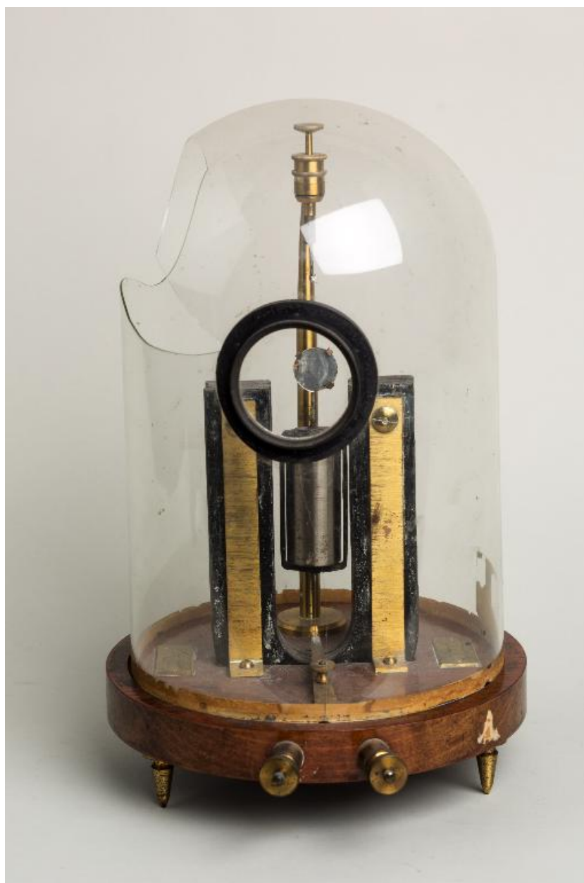
Galvanomètre Deprez d'Arsonval.
