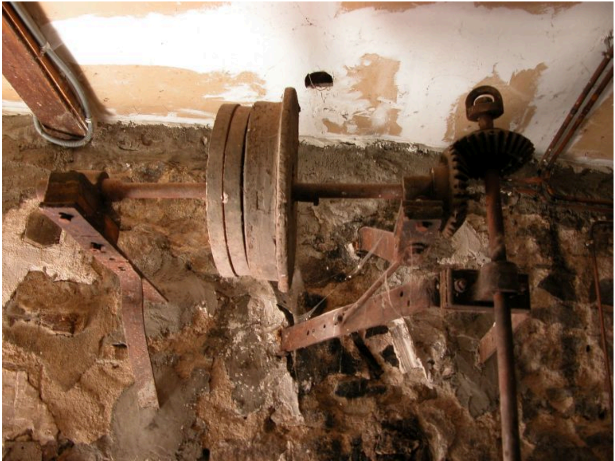
Détail des poulies d'entraînement de la cuve à chauffe.
