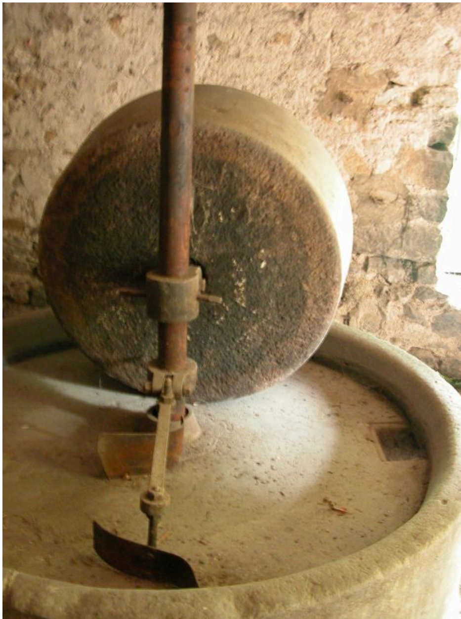
Détail des meules à broyer les noix.
