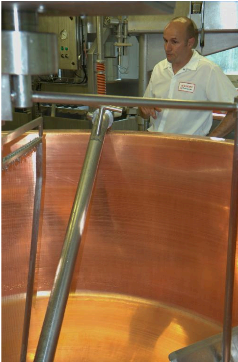
Vue d'ensemble du chaudron avec le tuyau d'amenée du lait.
