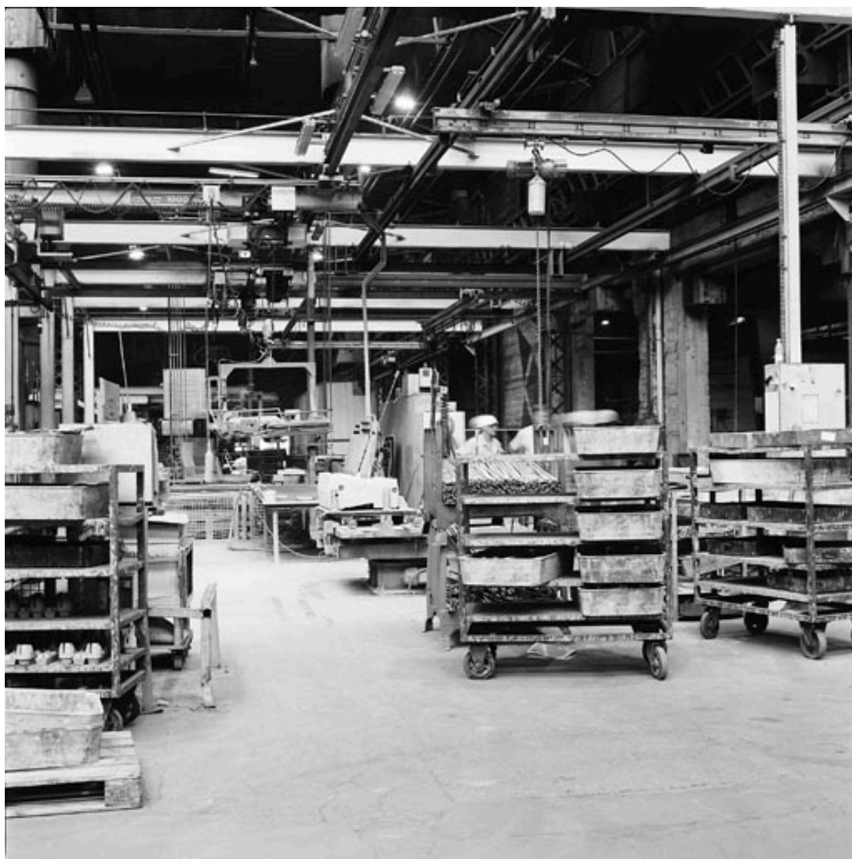
Ligne noyautage des blocs moteur, étuve.
