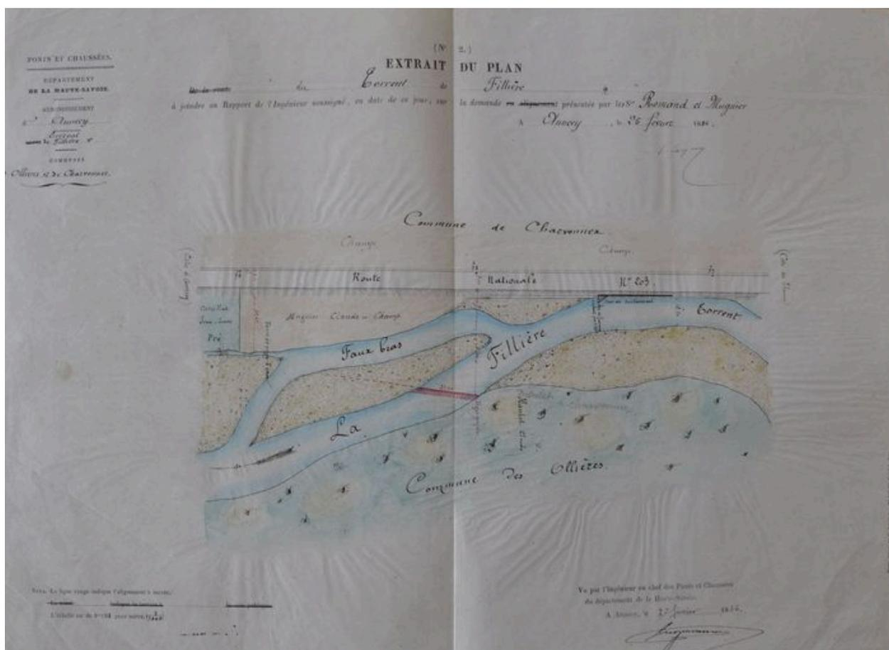
Extrait du plan de la Fillière du 25 février 1886 montrant le digue du barrage. Plan.
