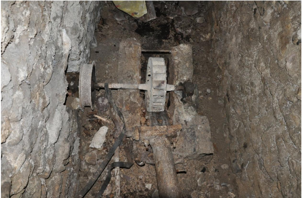
Vue de la roue métallique verticale, dit turbine, de l'atelier alimenté par les eaux du ruisseau le Grand-Ruisseau
