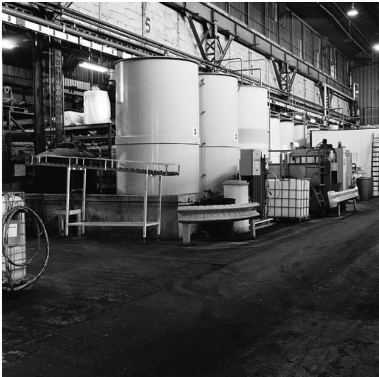
Usine moteur, grand hall : secteur filtration et régénération des huiles de coupes pour l'usinage des pièces moteur.
