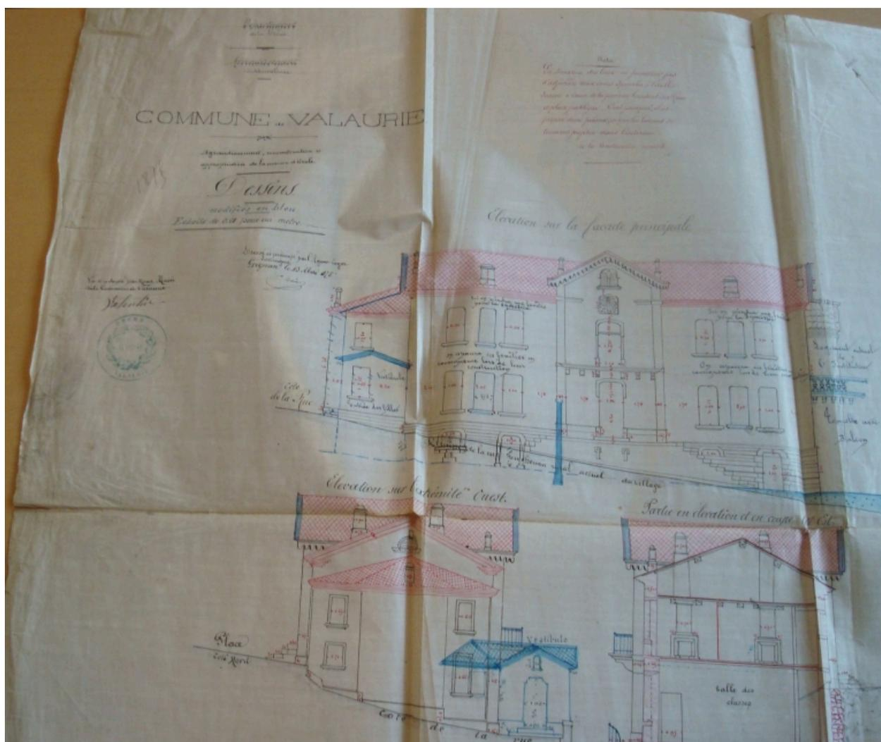
Commune de Valaurie. Agrandissement, reconstruction et appropriation de la maison d'école. Dessins modifiés en bleu. Elévation sur la façade principale - Elévation sur l'extrémité ouest - Partie en élévation et en coupe côté est (projet non réalisé).
