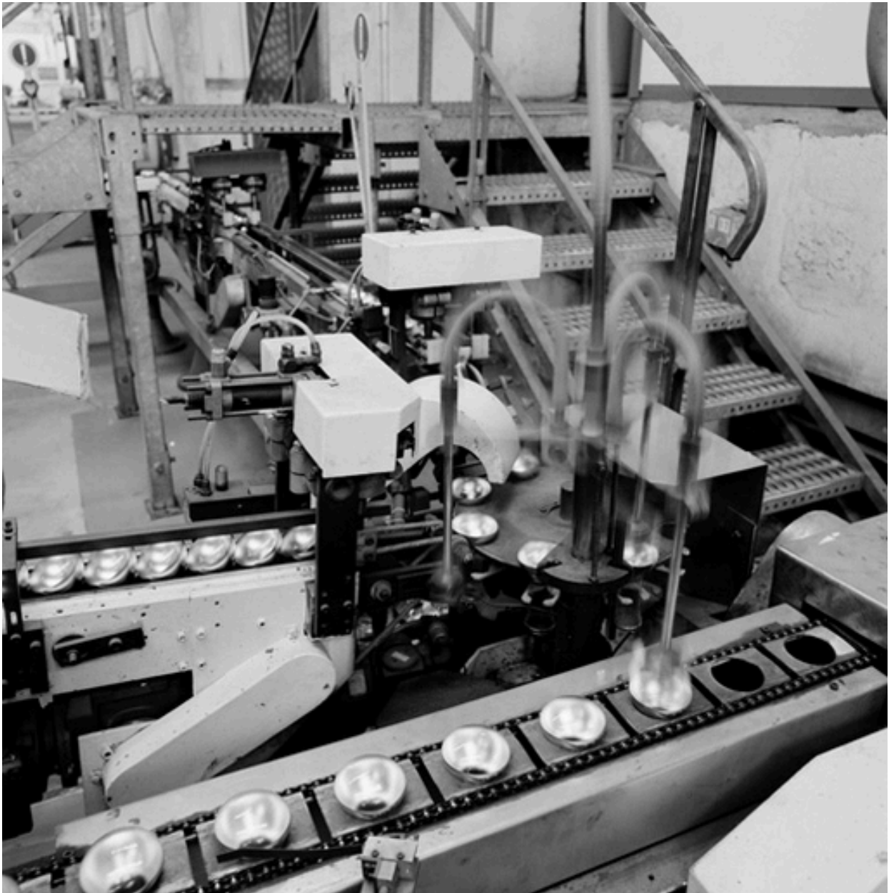
Mise en place des ballons
